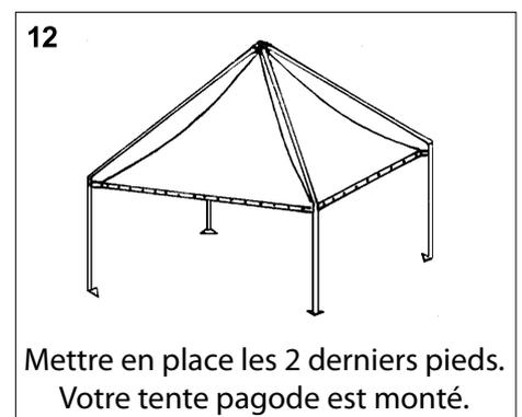
!/ Il est indispensable de lester la structure au sol (poids de lestages, piquets d'ancrages, scellement dans socle béton, ...)
